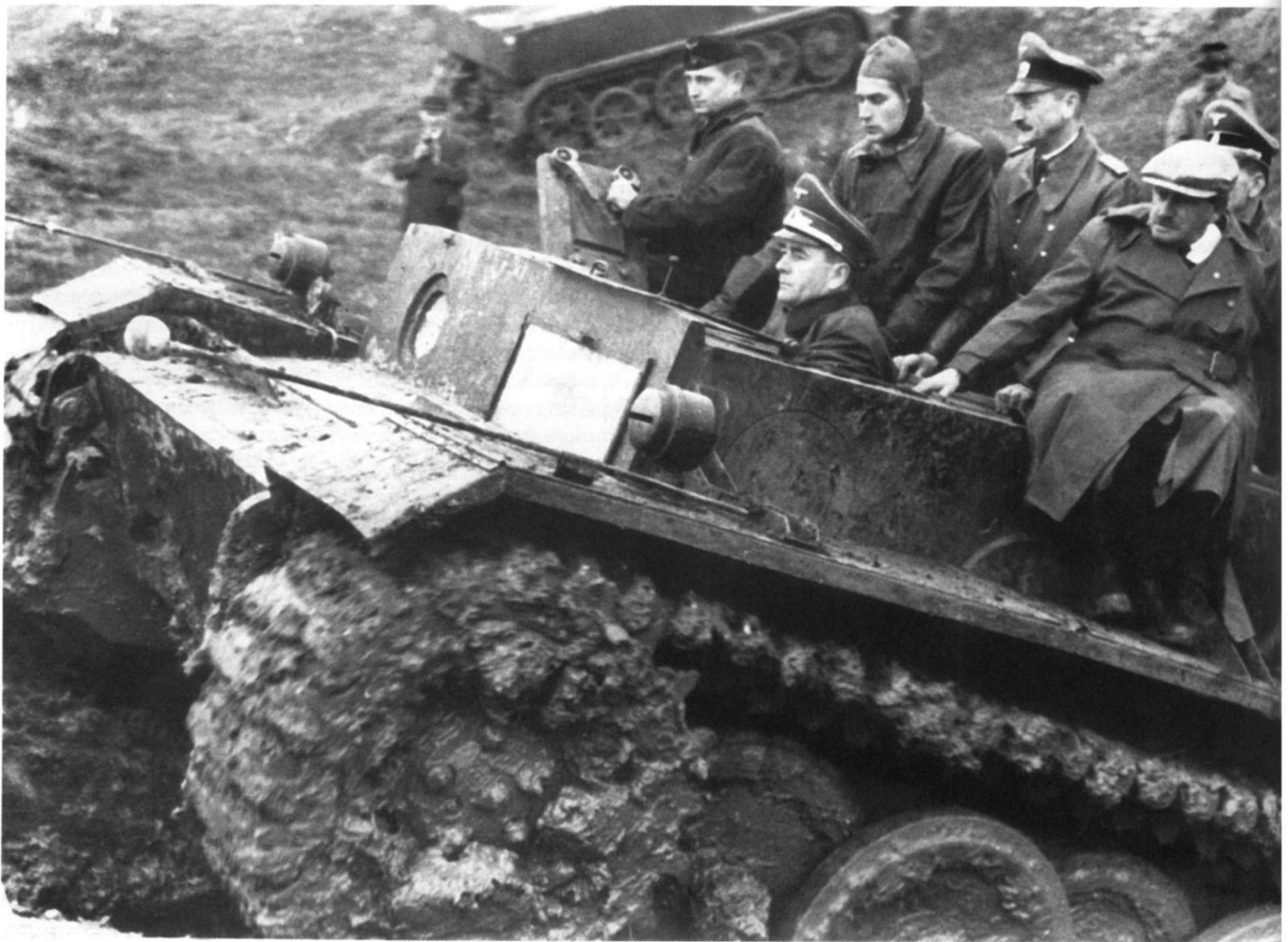
▲ Prototyp VK3601(H) podczas prób w ciężkich warunkach terenowych. W testach bierze udział minister Albert Speer. Na przedniej płycie pancernej brakuje wizjera kierowcy i jarzma karabinu maszynowego, których otwory zasłonięte są arkuszami szkła organicznego / via Hideya Ando
